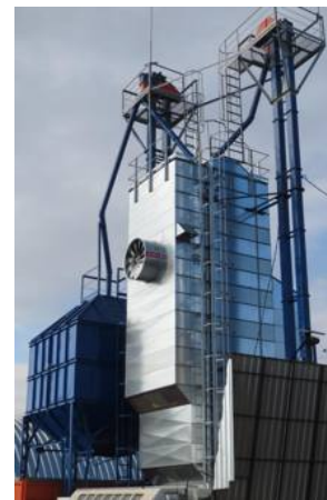
Сушилка 30 тонн в час с универсальной горелкой дизель/газ
