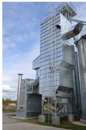
Сушилка 27 тонн в час с теплообменником
