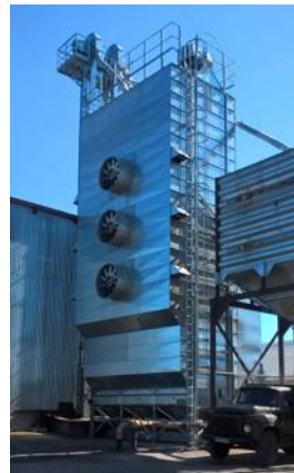
Сушилка 74 тонны в час с линейной горелкой
