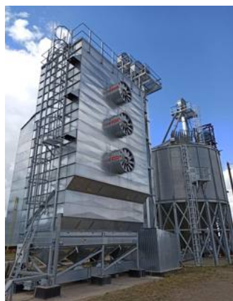
Сушилка 60 тонн в час с линейной горелкой
