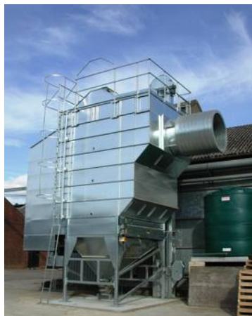
Сушилка 7 тонн в час на дизельном топливе с шумоподавелем
